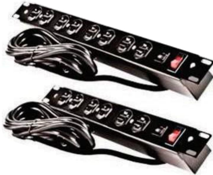
El Power Rack NACIONAL, permite la conexión de los equipos activos a la red eléctrica de manera segura. Diseñado según el estándar EIA, normalizada a 19 pulgadas, para que sea rackeado en un rack o gabinete ocupando solo 1RU. Presenta un Circuit Breaker de 15A, un switch con indicador de luz para la activación de las toma corrientes que cumplen con el estándar NEMA 5-15R
